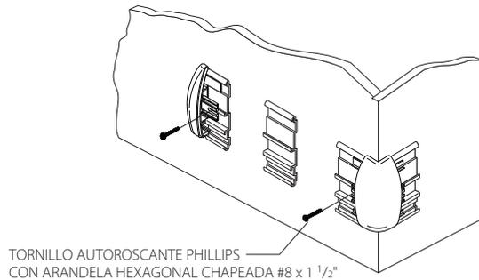
3. Deslice las tapas y esquinas sobre el apoyo del perfil de montaje y asegúrelas, dejando un espacio de 1/16" entre las partes anguladas/esquinas y el perfil para poder hacer ajustes.
