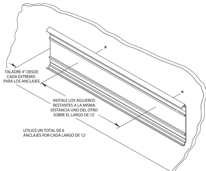
2. Taladre agujeros en la línea central del perfil de montaje utilizando una broca de 1/4" [6mm]. Posicione el perfil de montaje en la pared dejando espacio para las tapas y esquinas. Nivele y marque los agujeros. Ver Figura 2.
