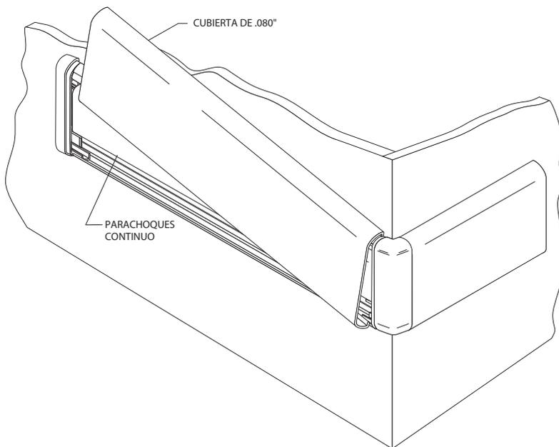
3. Taladre los agujeros marcados en la pared utilizando una broca de 1/4" [6mm] y posicione los anclajes de pinza ("Alligator") dentro de los agujeros. Instale el perfil de montaje en la pared y apriete los tornillos para que quede seguro. Deslice las tapas y esquinas sobre el perfil de montaje y asegúrelas, dejando un espacio de 1/16" [1.5mm] entre las partes anguladas/esquinas y el perfil para poder hacer ajustes. Ver Figura 3.
